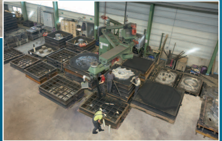
Formherstellung bis 3.000 x 3.000 mm mit einem 32t-Mischer Moulding by 3.000 x 3000 mm flask size with a 32t-Mixer
