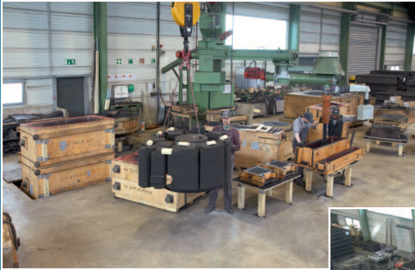
Kernfertigung mit einem 10t-Mischer Manufacturing of cores with a 10t-Mixer
